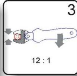
Klemmwirkung entspricht mehr als der 10fachen Betätigungskraft.
