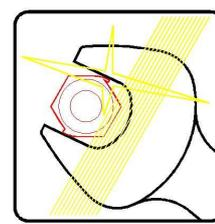
Kein verformen am 6-Kant durch spielfreie Varifix Klemmung. Anpresskräfte werden gleichmäßig auf 4 Seiten verteilt.
