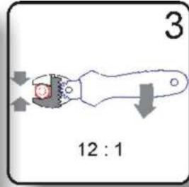
Klemmwirkung entspricht mehr als der 10fachen Betätigungskraft.
