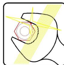
Kein verformen am 6-Kant durch spielfreie Varifix Klemmung. Anpresskräfte werden gleichmäßig auf 4 Seiten verteilt.
